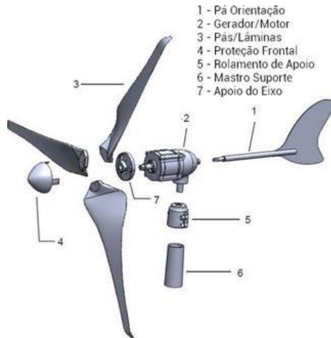
Figura 21 – Aerogerador de pequena dimensão
