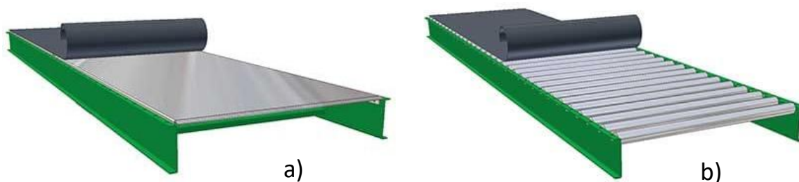
Figura 19 – Representação de tapete rolante (a) com chapa de fricção (b) com rolos livres, adaptado de [37]
