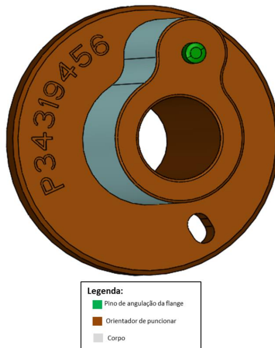
Figura 45 - Orientador de puncionar P34319456.
