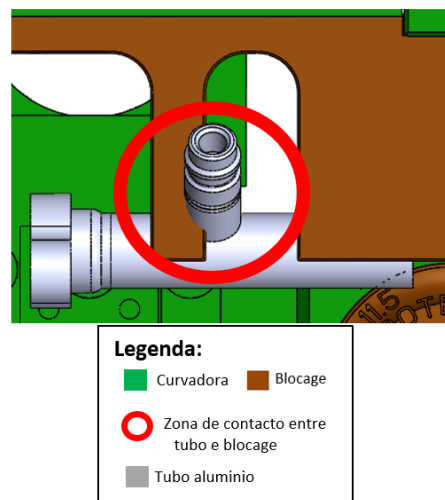
Figura 28 - Tubo em contacto com blocaje
