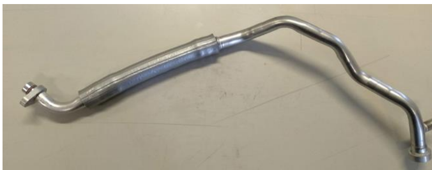
Figura 51 - Peça prensada em ambas as extremidades.
