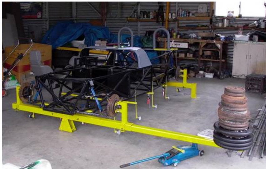
Figura 2.38: Ensaio da rigidez torsional encastrando as rodas traseira e aplicando um momento torçor com auxilio de uma viga que encastra as rodas frontais, Fonte:[18]
