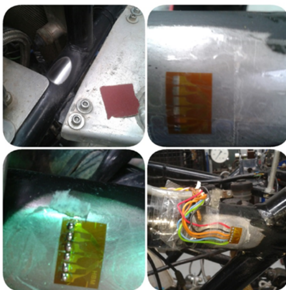
Figura 4.30: Preparação e colocação dos extensômetros
