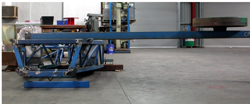
Figura 2.37: Ensaio da rigidez torsional encastrando a traseira e aplicando um momento torçor na frente com auxílio de uma viga, Fonte:[15]
