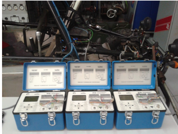
Figura 4.33: Equipamentos de leitura dos extensômetros
