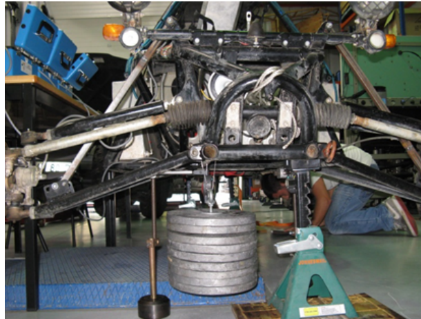
Figura 4.1: Aplicação da carga ao quadro do veículo
