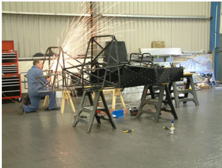
Figura 2.30: Exemplo de um quadro revestido/reforçado com chapas
