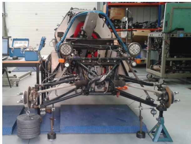
Figura 4.2: Aplicação da carga aos cubos de roda do veículo
