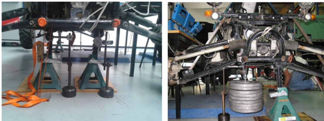
Figura 4.36: Condições de apoio do quadro
