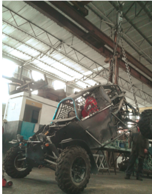
Figura 5.2: Pesagem do eixo traseiro do veículo levantando este com um ângulo superior a 20^\circ
