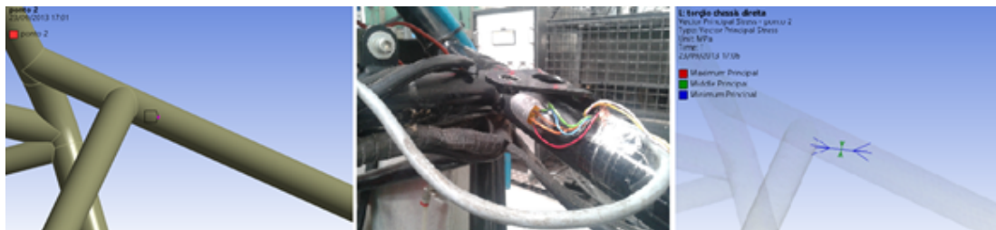
Figura 4.8: Ponto 2 escolhido para a colocação da roseta e no lado oposto foi colocado um extensómetro unidirecional
