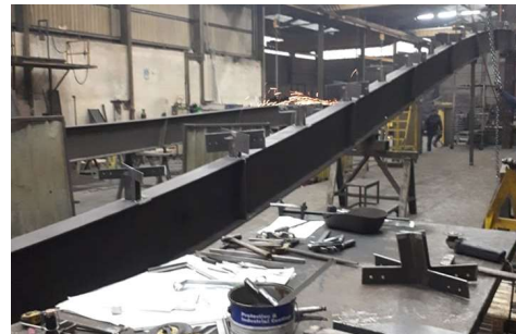
Figura 7 - Viga PRS ondulada (elaboração própria)
