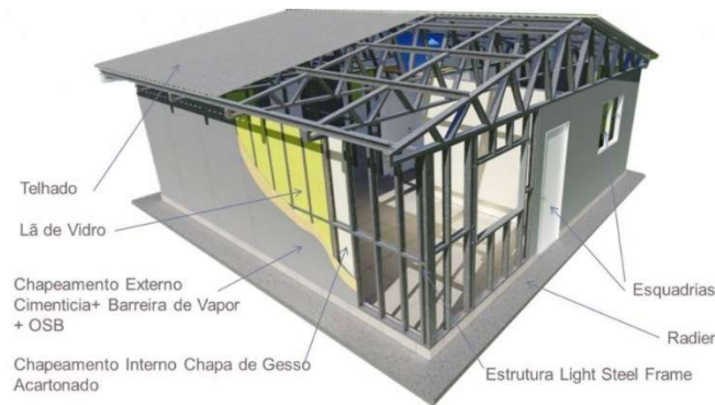
Figura 8 - Construção em LSF [14]
