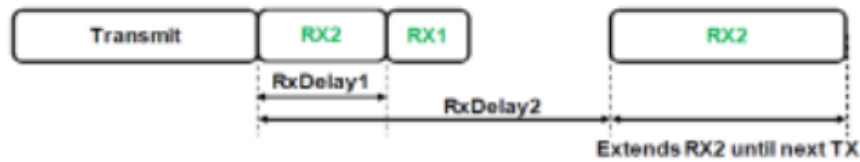
Figura 2.10: Janela de Recepção de Dispositivos Classe C [6].
