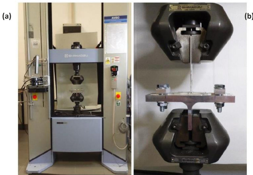
Figura 51 - Ensaio das juntas em T: (a) MTS utilizada e (b) encastramento do substrato base (adaptado de [1])
