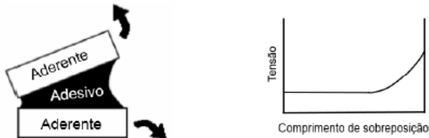
Figura 13 - Diagrama de esforço de clivagem com distribuição de tensões (adaptado de [6]).
