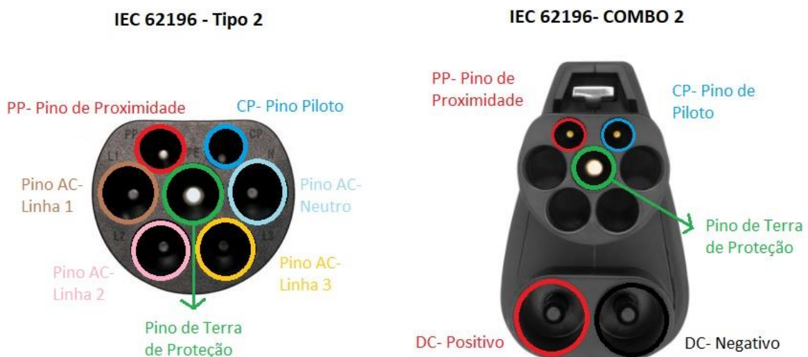
Figura 4- Descrição de cada pino dos conectores IEC 62196 Tipo 2 e COMBO 2
