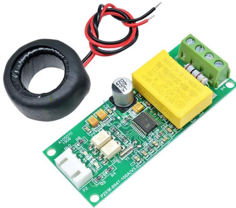
Figura 29- Aspetto físico do PZEM-004T-100A V3
