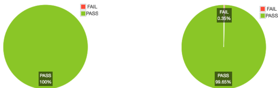
(a) No caso do monólito os pedidos tiveram 100% de sucesso. (b) No caso dos micro-serviços houve uma percentagem de 0,35% de erros.
