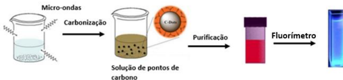
Figura 2.18. Síntese de CDoT por micro-ondas assistida.
