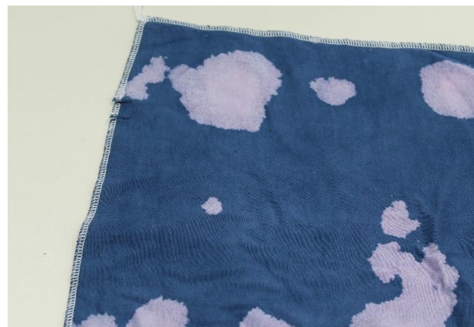
Figura 49: Resultados da aplicação de 100 g/L de Nofelding RE
