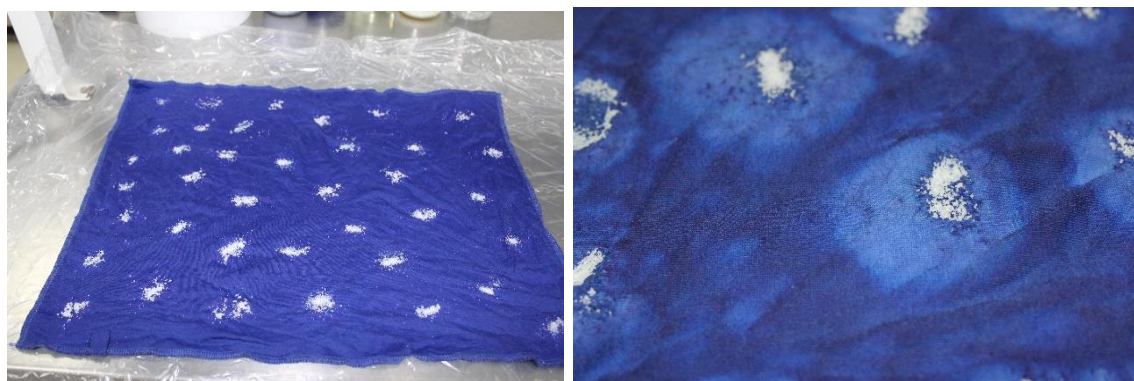
Figura 30: Acabamento aguarela realizado apenas com sal
