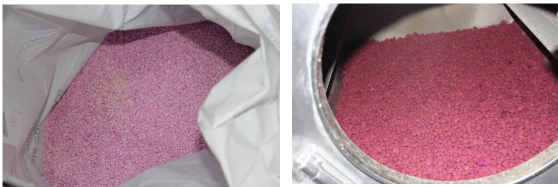
Figura 25: Perlita (à esquerda) e pedra pomes (à direita) utilizados na empresa para a realização do fade out.
