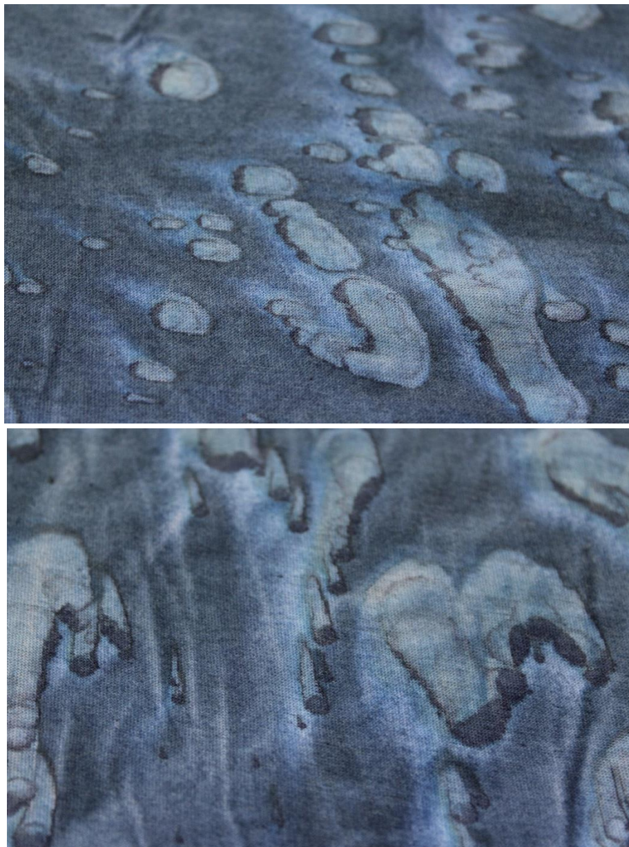
Figura 57: Acabamentos manchados devido à elevada temperatura a que foram sujeitos durante a fixação
