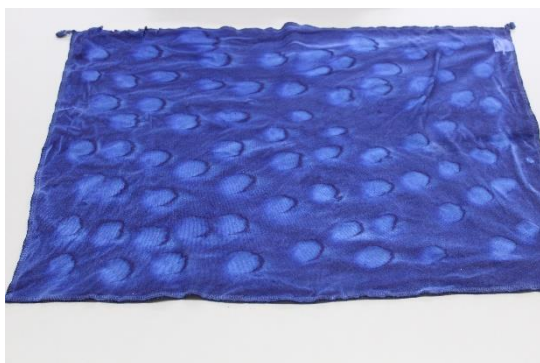
Figura 54: Resultado do acabamento aguarela realizado apenas com RialResin Fluo
