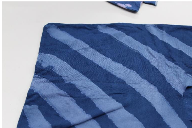
Figura 46: Resultados da aplicação de 30 g/L de Nofelding RE
