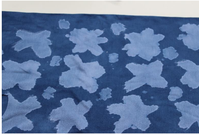
Figura 47: Resultados da aplicação de 60 g/L de Nofelding RE
