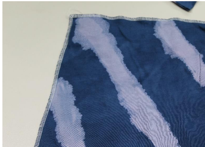
Figura 48: Resultados da aplicação de 80 g/L de Nofelding RE
