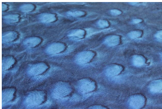
Figura 54: Resultado do acabamento aguarela realizado apenas com RialResin Fluo
