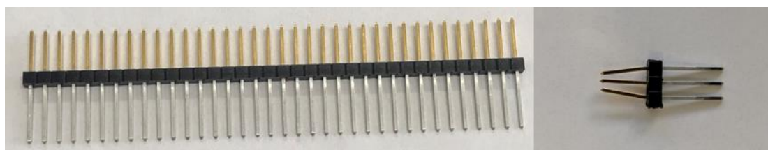
Figura 2.4: Forma do conjunto de pinos (esquerda) e forma dos três pinos que possibilitam a medida eletroquímica (direita).
