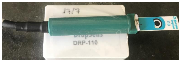
Figura 2.6: Fotografia do SPCE inserido do cabo conector, de modo a possibilitar a medição voltamétrica.
