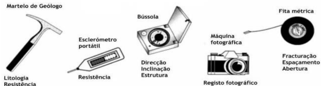
Figura 11 - Equipamento de campo básico para a cartografia geoestrutural, geotécnica e geomecânica de maciços rochosos fraturados (adaptado de Gonzalez de Vallejo & Ferrer, 2011).
