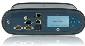
Figura 2 Analisador de rede utilizado na monitorização da rede elétrica.
