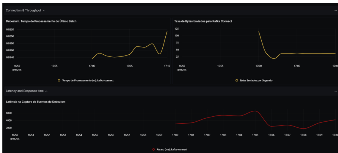
Figura 4.27 - Dashboard de análise do sistema de CDC no SigNoz com métricas equivalentes ao Grafana.
