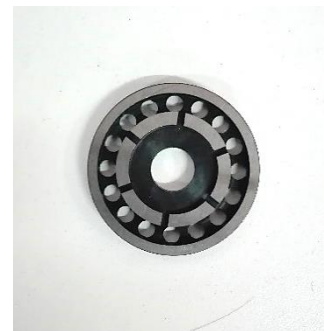
Figura 3.5 Emulsor do queimador da caldeira nº 2
