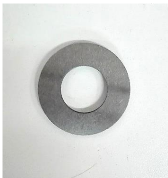
Figura 3.6 Separador do queimador da caldeira nº 2
