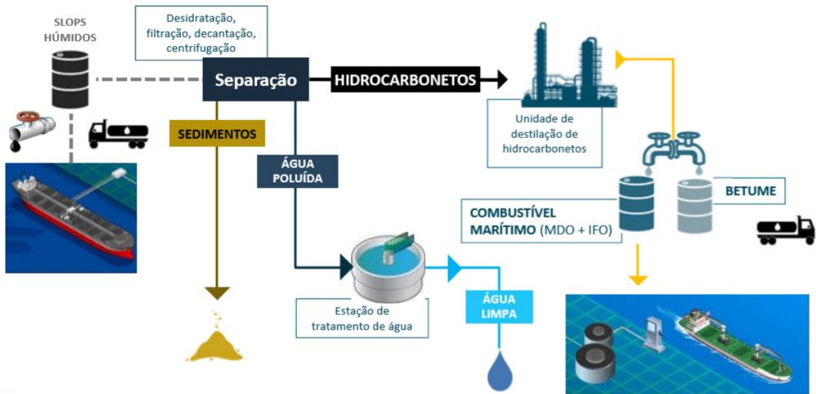
Figura 2.3 Processo de coleta e produção do combustível marítimo utilizado [28]
