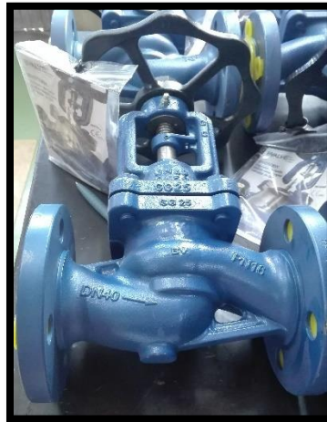
Figura 2.9 Válvula globo DN 40 PN 16 utilizada na instalação
