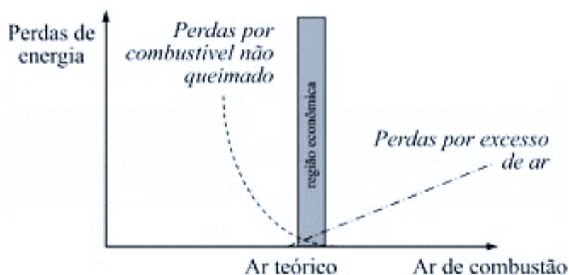
Figura 2.5 Efeito do excesso de ar sobre as perdas em sistemas de combustão [14]
