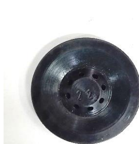
Figura 3.7 Multibús do queimador da caldeira nº 2
