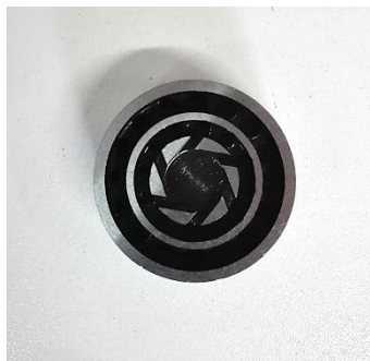
Figura 3.3 Atomizador do queimador da caldeira nº 2
