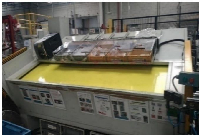
Figura 126 - Cabine da máquina de teste de estanquicidade fechada
