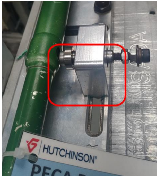
Figura 153 - Peça de acerto mal orientada
