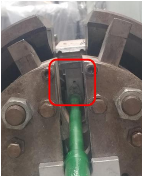
Figura 151 - Sistema de orientação da flange antes da colocação do pino
