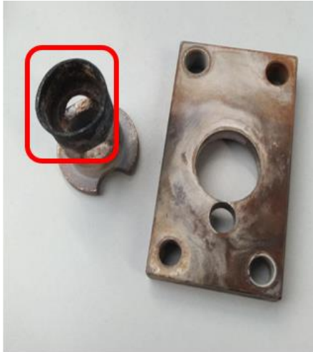
Figura 136 - Colocador de solda queimado
