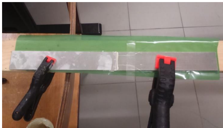
Figura 40 – Grampos para garantir fixação da junta durante a cura.
