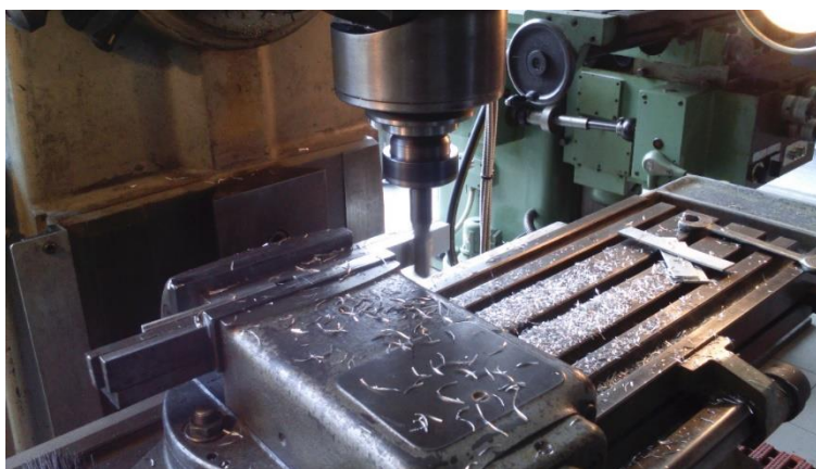
Figura 37 – Maquinação de junta de chanfro interior de 3,43^\circ .
