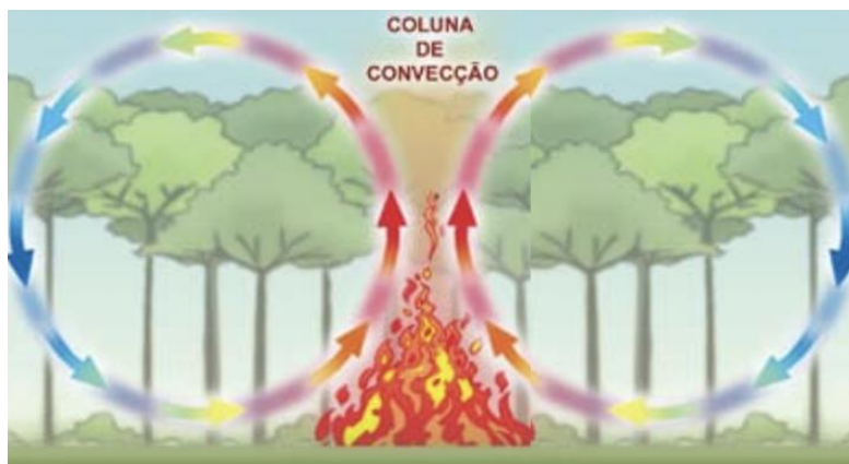
Figura 2.4: Correntes e coluna de convecção [12].
