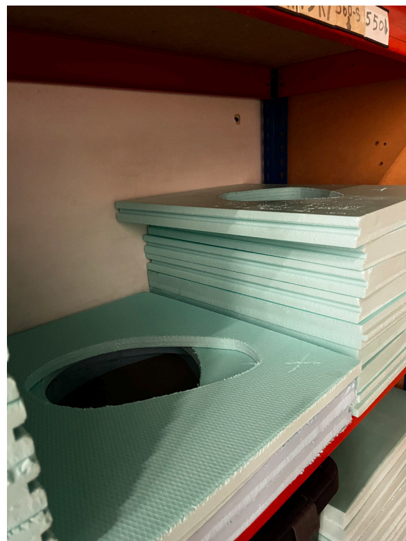
Figura 49 – Placas de Roofmate Pré-Cortadas, da autora, 2026.
