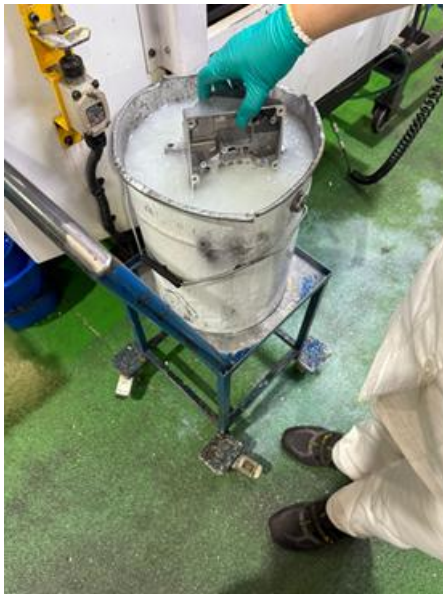
Figura 25 - Lavagem da peça Motor Housing 800V
