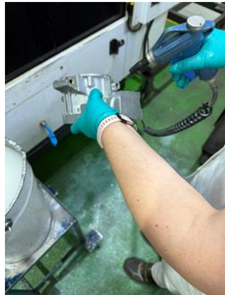
Figura 26 - Secagem da peça Motor Housing 800V
