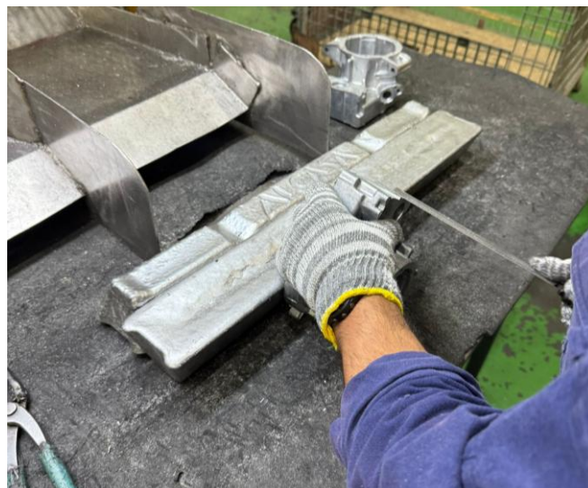
Figura 16 - Acabamento primário da peça após sair da célula de fundição
