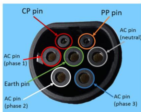
Figura 5 - Pinos do conector AC tipo 2 [11]
