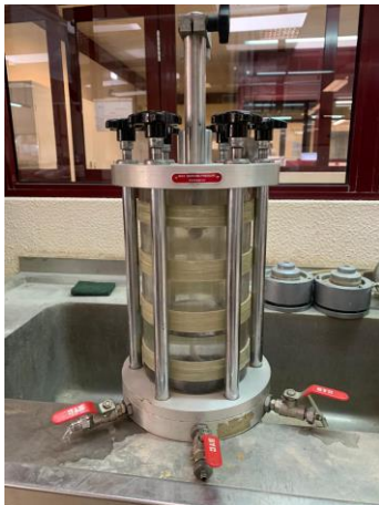
a) Remoção do líquido da câmara triaxial.
