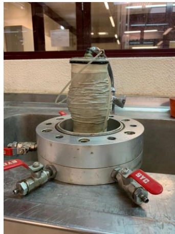
b) Remoção da tampa da câmara triaxial.
