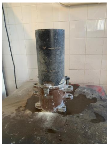
Figura 7 - Execução do ensaio para determinação do e_{mín} e e_{máx} .
