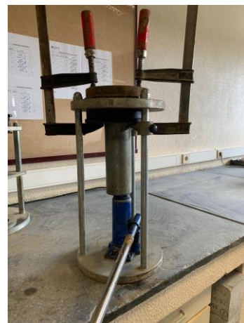
d) Extração do provete do molde.
