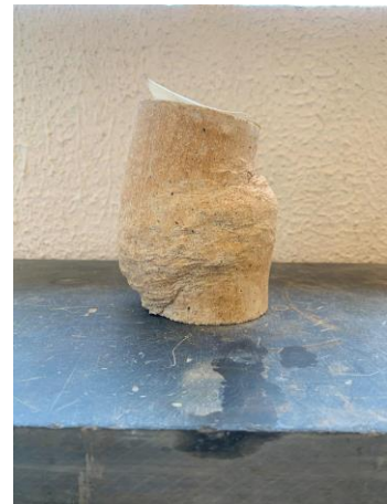
c) Captura do plano de rotura do provete.
