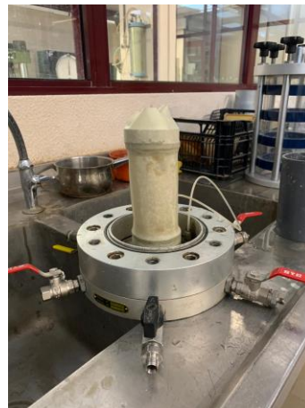
b) Colocação da membrana isolante.
