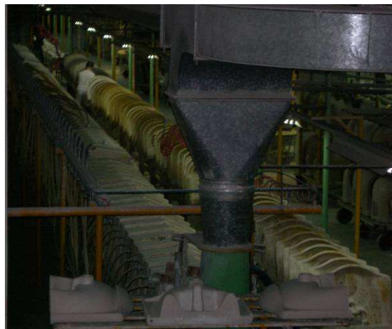
Figura 7 – a) Bancas de enchimento das peças; b) bateria de enchimento.
