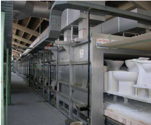
Figura 16 – a) Vista lateral do forno 4; b) saída das peças cozidas.
