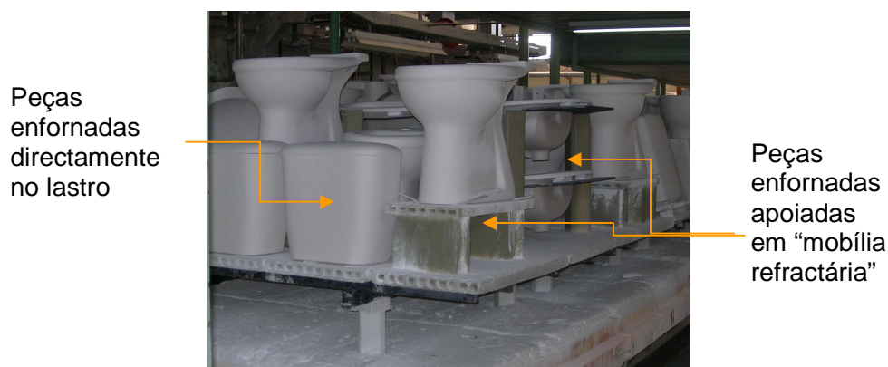
Figura 20 – Peças enfornadas directamente no lastro e apoiadas na móbilía refractária.
