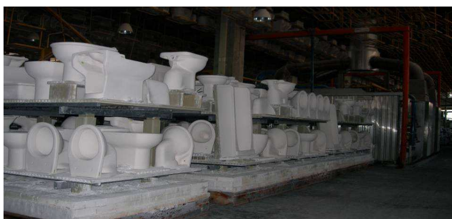
Figura 15 – Vagonas carregadas à espera para entrar no forno 3i.
