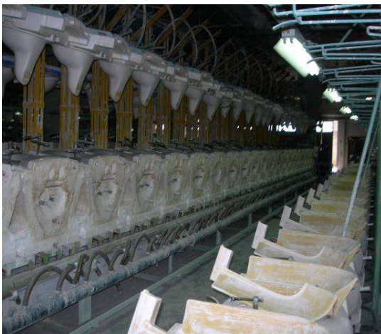
Figura 7 – a) Bancas de enchimento das peças; b) bateria de enchimento.
