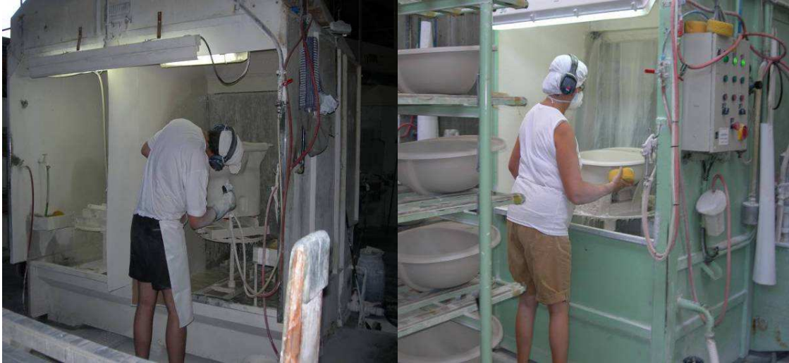
Figura 12 – Vidragem de uma peça numa cabine.
