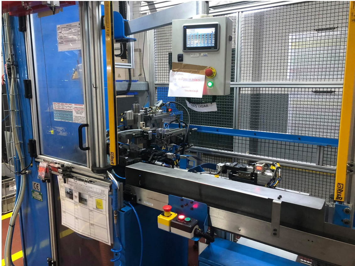
Figura 37 – 2ª Injeção do terminal de zamak e controlo de qualidade
