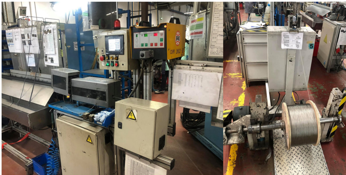
Figura 32 – Corte do cabo de aço
