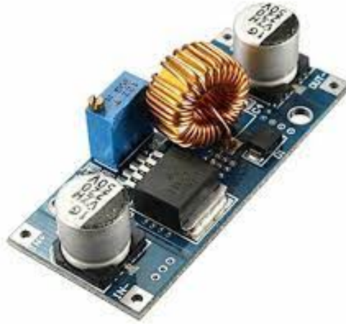
Figura 3.10: Conversor abaixador de tensão [46].
