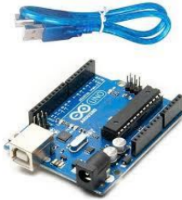
Figura 3.21: Placa de Arduino Uno com microcontrolador AT-Mega328P [55].
