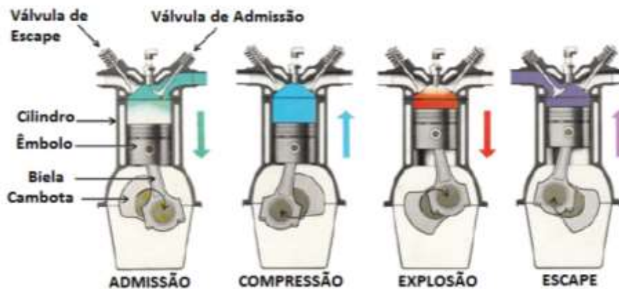
Figura 2.13 - Representação esquemática do ciclo de um motor de ignição por faísca [22].
