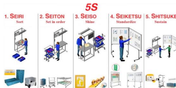
Figura 12 - Esquemático da metodologia 5S (Veres et al., 2018)
