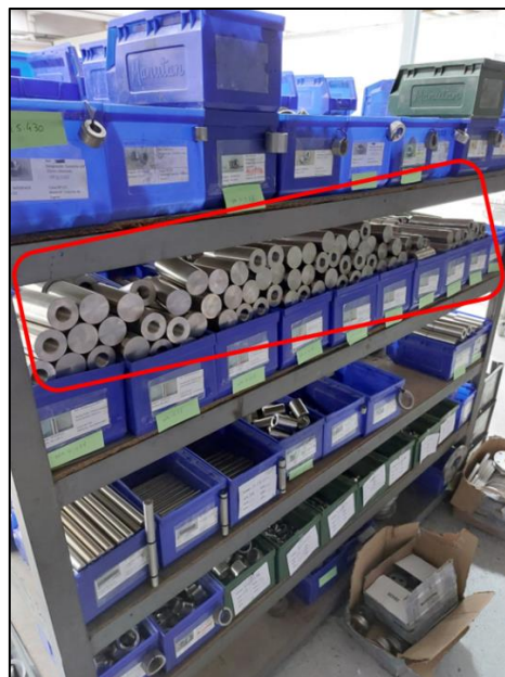
Figura 89 - Contentores com excesso de material (Elaboração Própria)
