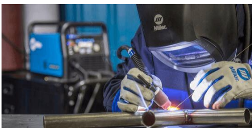
Figura 11 – Exemplo de soldadura TIG.
