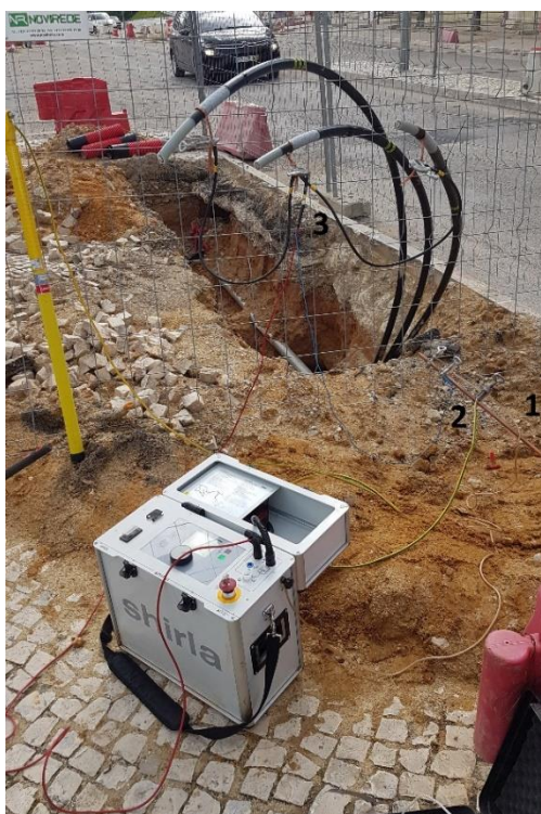
Figura 13- Esquema de ligações: tensão contínua da bainha exterior
