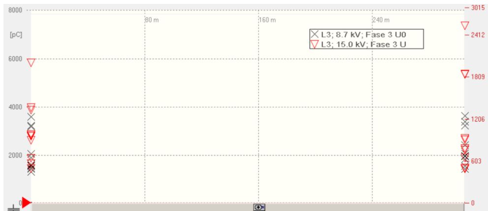
Figura 39- Descargas parciais verificadas na fase 3
