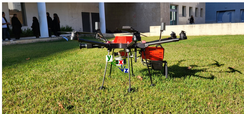
Figura 4.11: Posicionamento do LiDAR no UAV.
