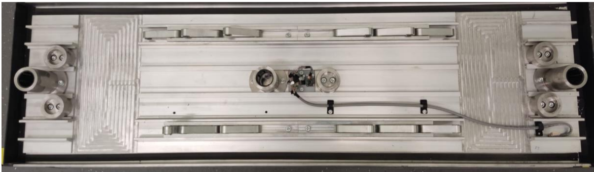
Figura 6.1 – Sensores instalados no módulo mecânico
