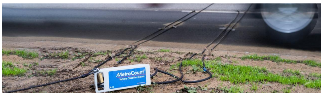
Figura 2.5 – Sistema de monitorização por tubagens pneumáticas [20]
