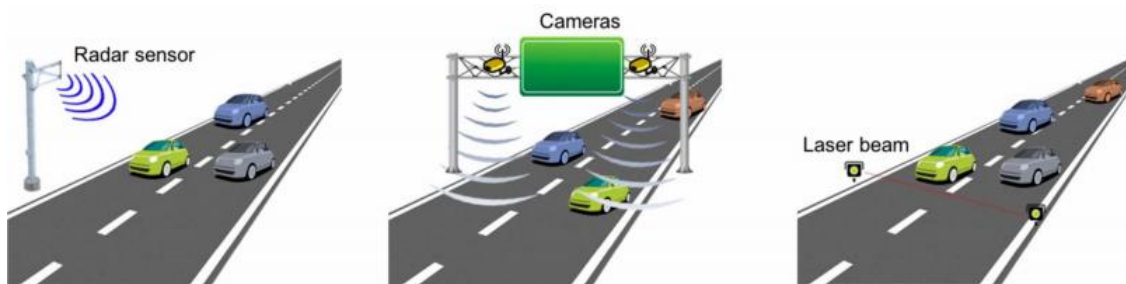
Figura 2.3 – Tipos de sensores de sistemas de monitorização não intrusiva [17]
