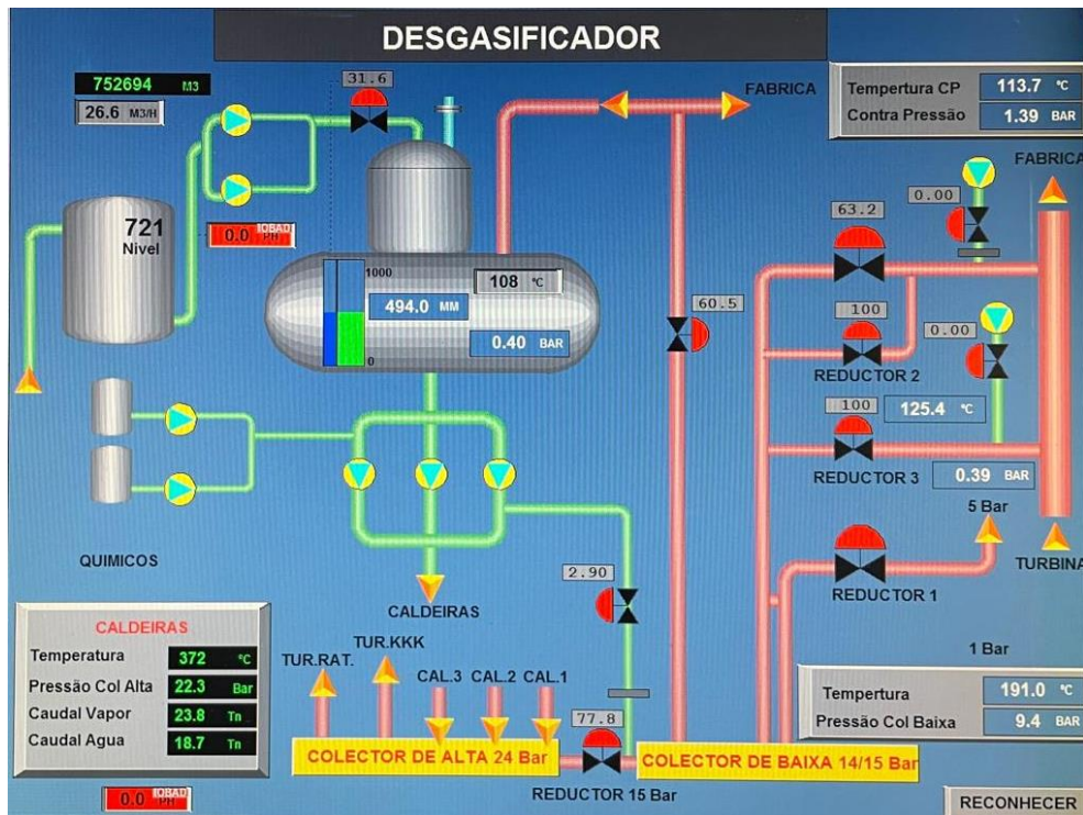
Figura 3.8 - Painel de monitorização do desgasificador
