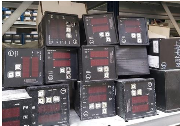
Figura 18 - Controladores de temperatura
