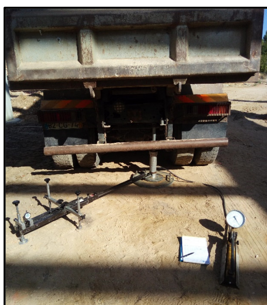
Figura 23 – Ensaio de carga em placa, com a placa de 300mm (fotografia da esquerda) e de 600mm (fotografia da direita), equipamento necessário e dispositivos/equipamentos de reação (compactador e camião).
