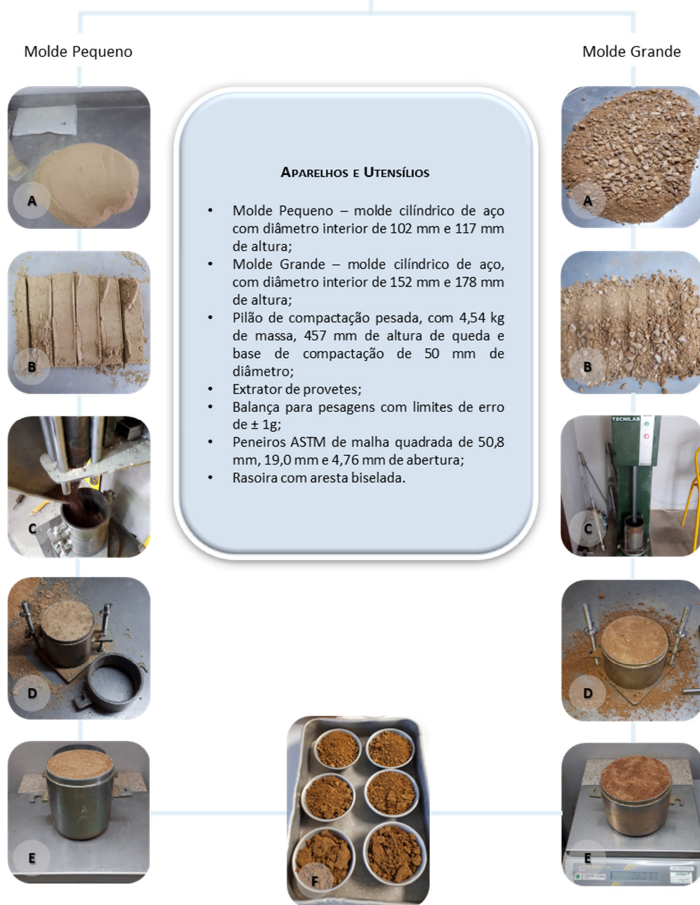
Figura 32 - Esquema ilustrativo da técnica de execução do ensaio de compactação pesada, em molde grande ou pequeno.
