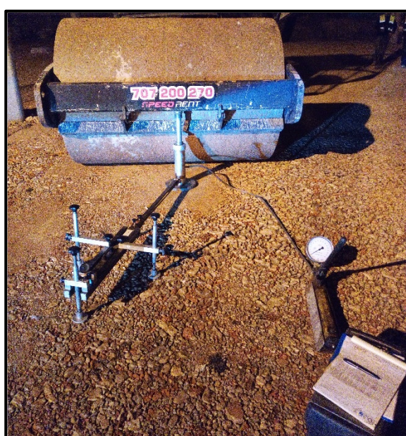
Figura 23 – Ensaio de carga em placa, com a placa de 300mm (fotografia da esquerda) e de 600mm (fotografia da direita), equipamento necessário e dispositivos/equipamentos de reação (compactador e camião).
