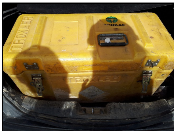
Figura 22 - Gamadensímetro (troxler) e a sua caixa revestida.
