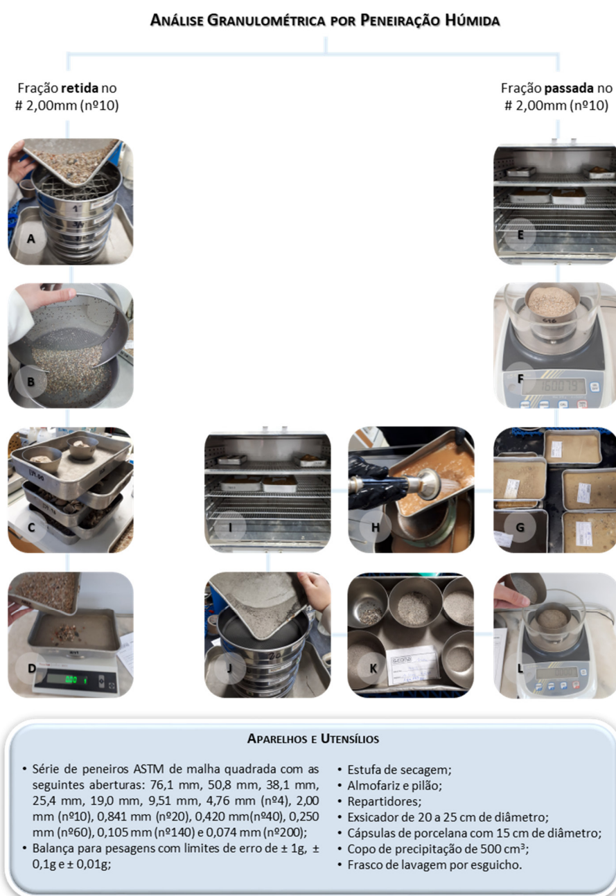
Figura 28 - Esquema ilustrativo da técnica de execução da análise granulométrica por peneiração húmida.
