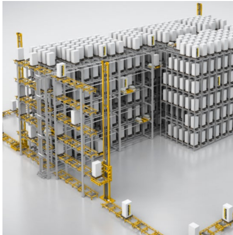
Figura 18 – Aplicação do sistema carro satélite
