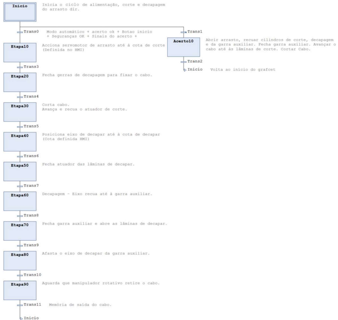
Figura 72 - Sequência do corte e decapagem esquerdo
