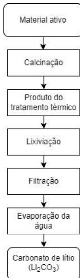
Figura 46 – Fluxograma da reciclagem do lítio através de pirometalurgia [113].
