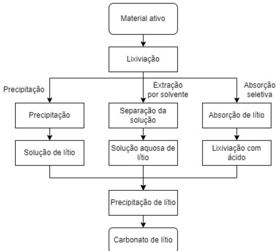
Figura 47 - Fluxograma da reciclagem do lítio através de hidrometalurgia [113].
