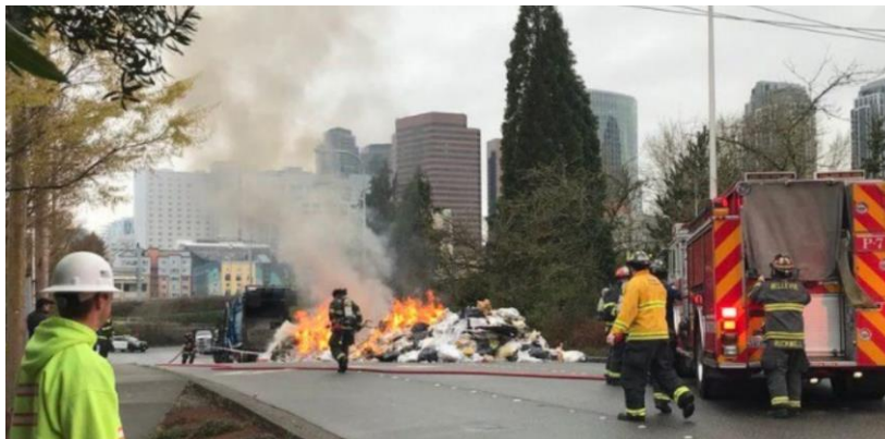
Figura 50 - Incêndio em um veículo de recolha de lixo comum causado por uma bateria de lítio [121].
