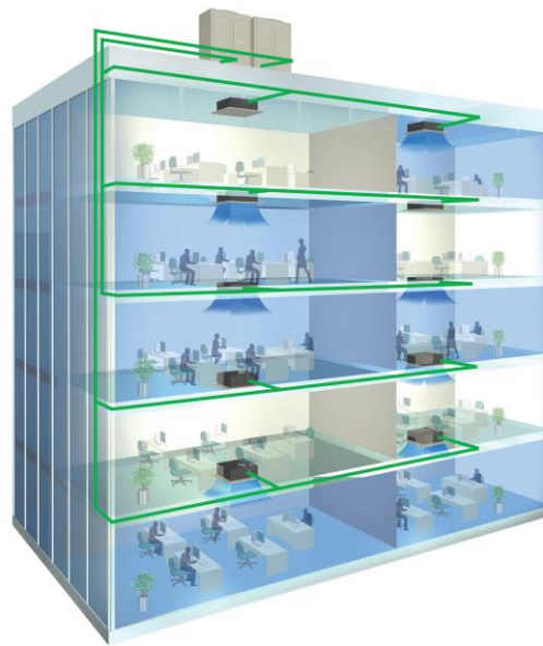
Figura 17 – Representação de um sistema VRF [60]
