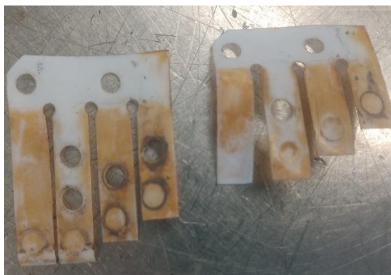
Figura 26 - Palhetas em mau estado
