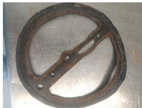
Figura 24 - Vedante com presença de oxidação
