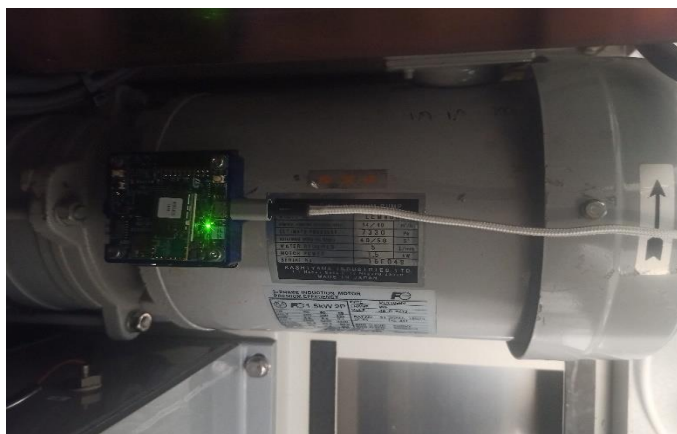
Figura 36 - Sensor STEVAL-STWINKT1B implementado
