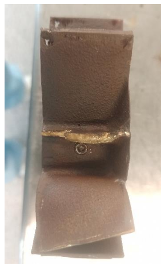
Figura 22 - Lâmina do rotor quebrada
