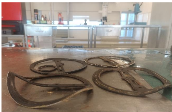
Figura 23 - Vedantes com perda de forma
