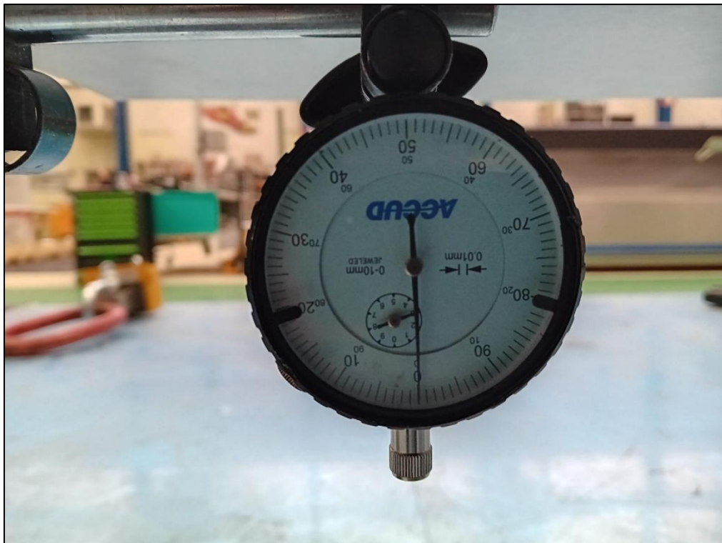
Figura 88 - Condição Inicial Medições Deslocamento Vertical do Cabeçote
