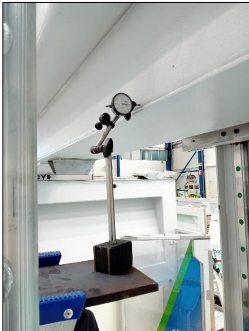
Figura 36 - Relógio Comparador Instalado na Ponte (Deslocamento Transversal)
