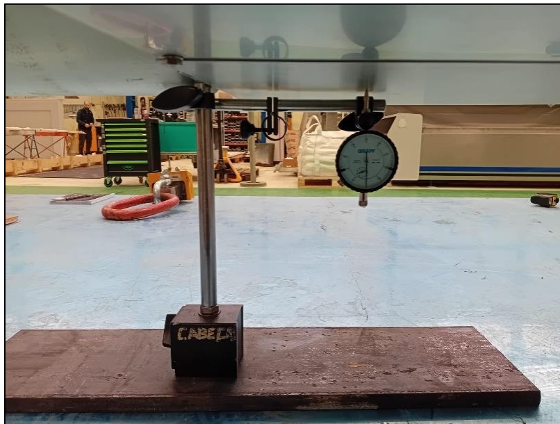
Figura 35 - Relógio Comparador Instalado no Cabeçote (Deslocamento Vertical)
