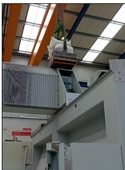
Figura 41 - Ilustração da Situação de Carga Inicial Setup II no Montante Direito
