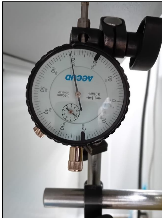
Figura 103 - 4ª Medição (Peso Próprio da Ponte)
