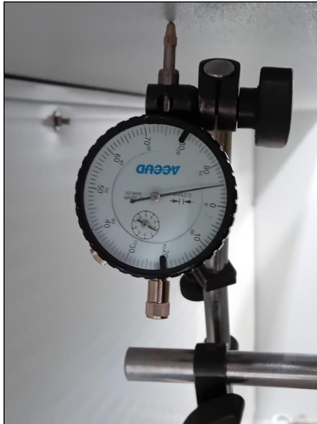
Figura 97 - 3ª Medição (Variação de Carga 750 kg)
