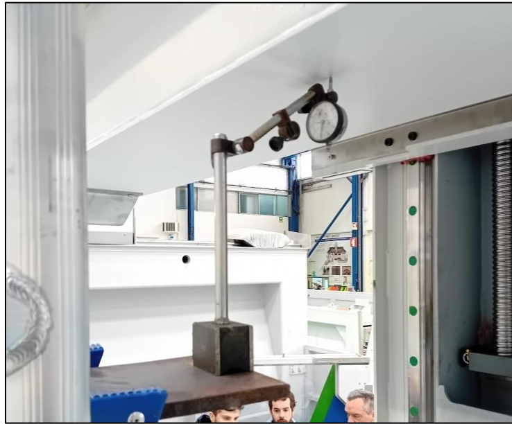
Figura 34 - Relógio Comparador Instalado na Ponte (Deslocamento Vertical)
