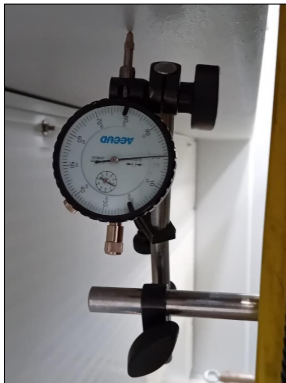
Figura 94 - Condição Inicial Medições Deslocamento Vertical do Montante Esquerdo
