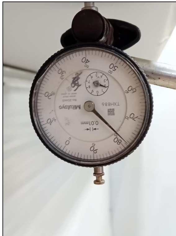
Figura 105 - 4ª Medição (Peso Próprio da Ponte)
