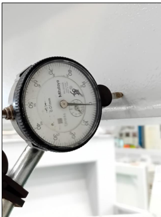
Figura 86 - Condição Inicial Medições Deslocamento Transversal da Ponte
