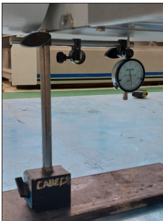
Figura 89 - 1ª Medição (Variação de Carga 250 kg)
