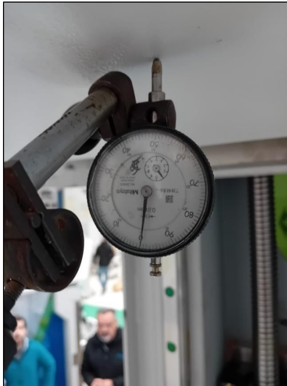
Figura 82 - Condição Inicial Medições Deslocamento Vertical da Ponte
