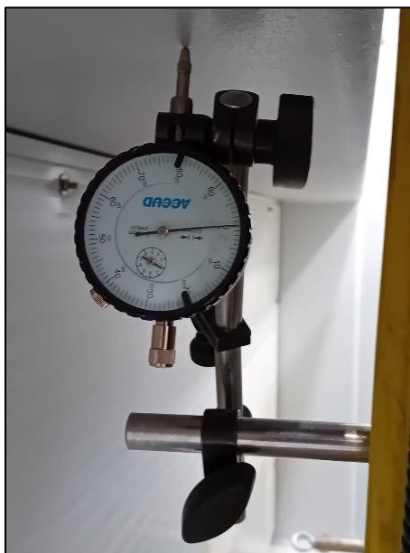
Figura 39 - Relógio Comparador Instalado no Montante Esquerdo
