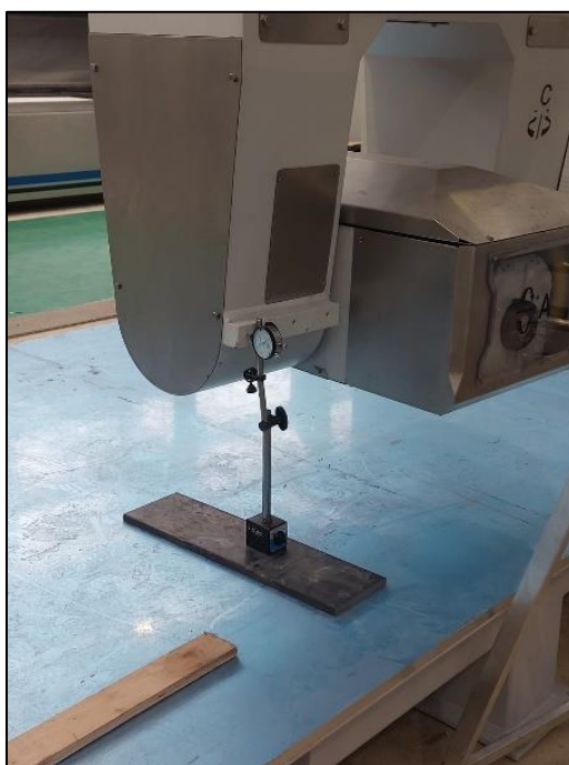
Figura 37 - Relógio Comparador Instalado no Cabeçote (Deslocamento Transversal)
