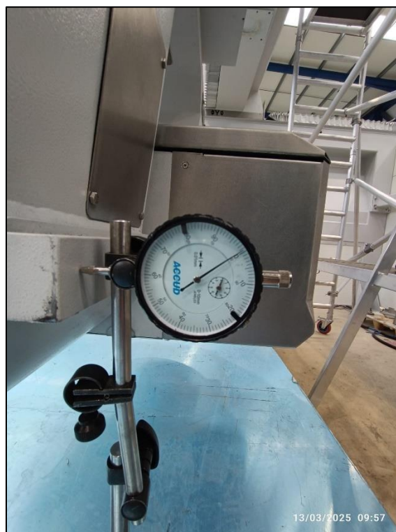
Figura 92 - Condição Inicial Medições Deslocamento Transversal do Cabeçote
