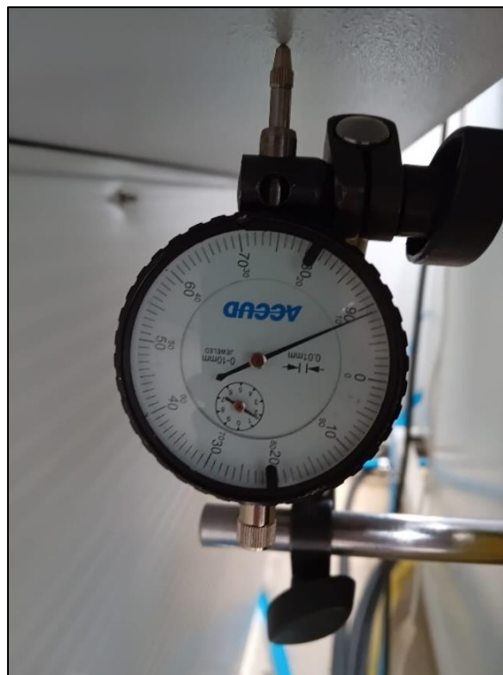
Figura 102 - Condição Inicial Medições Deslocamento Vertical do Montante Esquerdo
