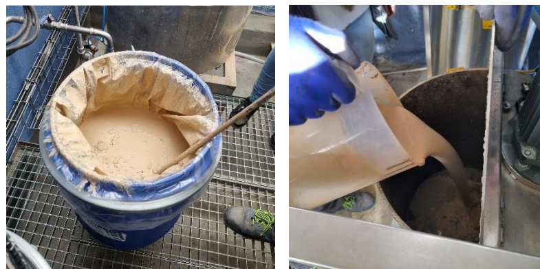
Figura 17– Introdução manual de químicos nas balanças das máquinas de revestir.
