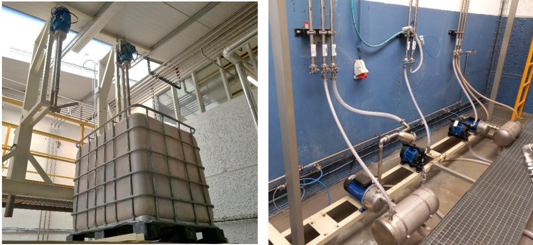
Figura 33 - Sistema de introdução automática de químicos no setor dos revestimentos.
