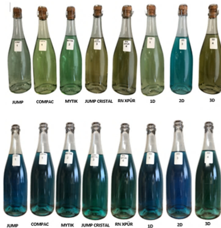
Figura 4.13 – Aspeto das garrafas com solução-modelo de azul de metileno e diferentes rolhas ao fim de 70 dias a) antes e b) após abertura.
