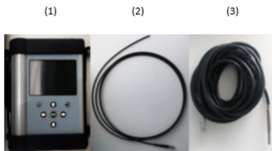
Figura 3.7 - Equipamento utilizado na técnica de medição da fotoluminescência: (1) Equipamento; (2) Fibra ótica; (3) Sensor de temperatura.
