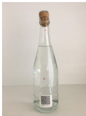
Figura 2.12 - Garrafa com os microsensores PreSens utilizada na técnica de medição da fotoluminescência.
