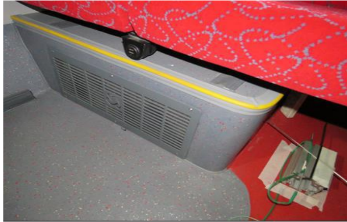
Figura 76 Entrada da ventilação frontal no salão dos passageiros
