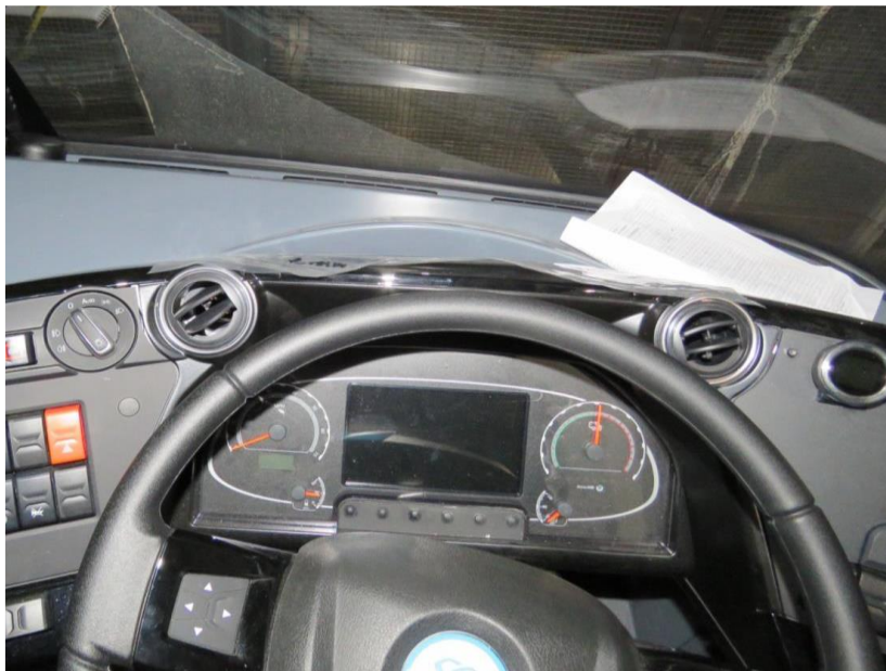
Figura 72 Ventiladores de ar do painel na cabine do motorista
