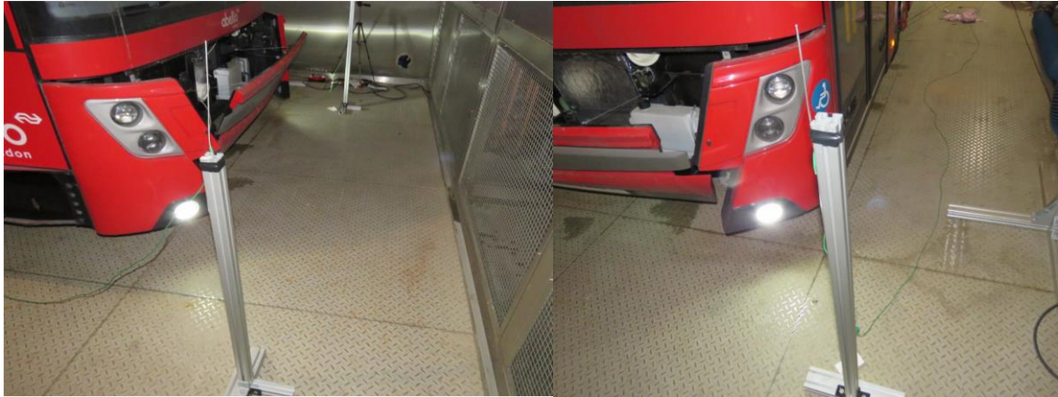
Figura 79 Sensores de temperatura ambiente da câmara na parte LD e LE frontal
