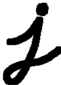
Figura 30 – Resultado da operação de erosão 24
