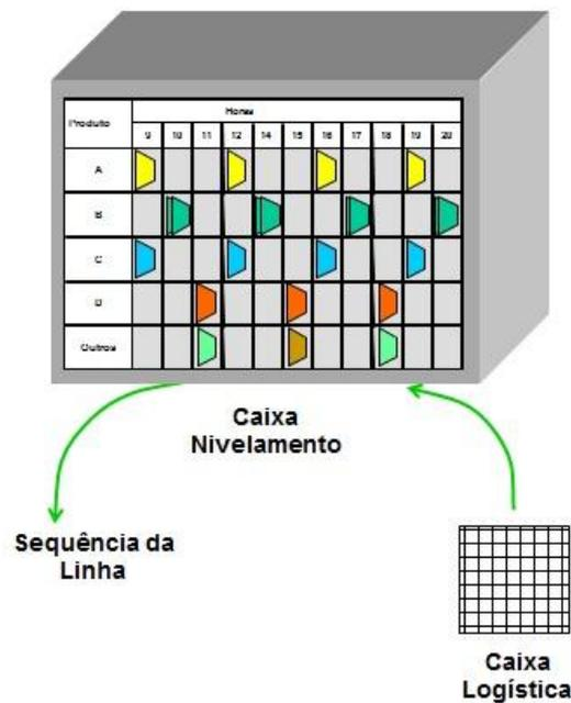
Fig. 34- Caixa de Nivelamento
