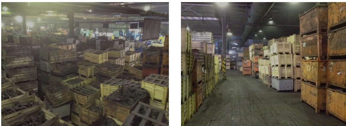
Fig. 81- WIP entre a moldação e acabamentos
