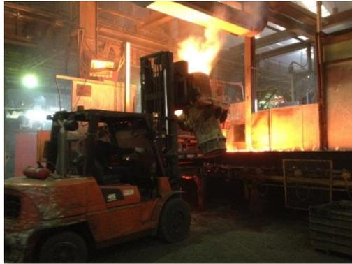
Fig. 57- Colocação do ferro fundido na bacia de vazamento
