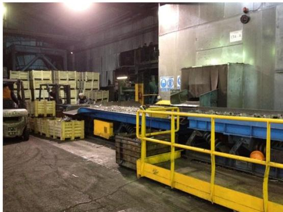
Fig. 60- Saída das peças das granalhadoras onde ocorre a separação
