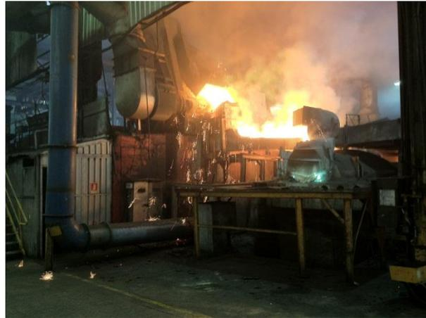
Fig. 47- Forno de indução a fornecer ferro fundido ao forno de manutenção
