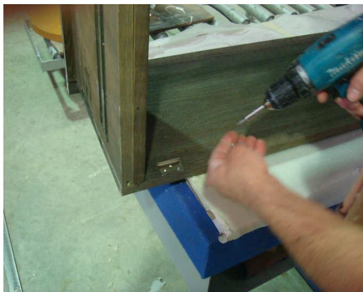
Figura 30 – Secção de montagem 2 (incorporação de ferragem)
