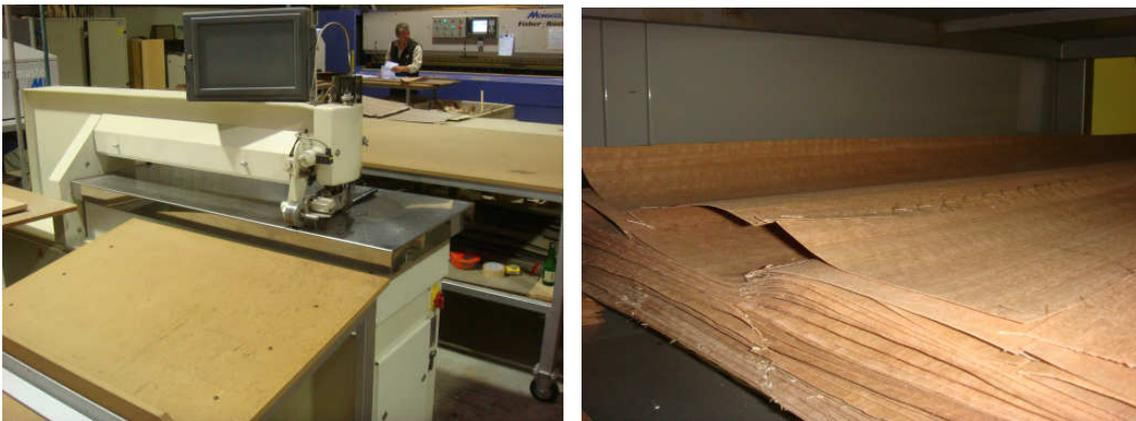
**Figuras 16 e 17 – Secção de folheamento (corte e união de folha)**
