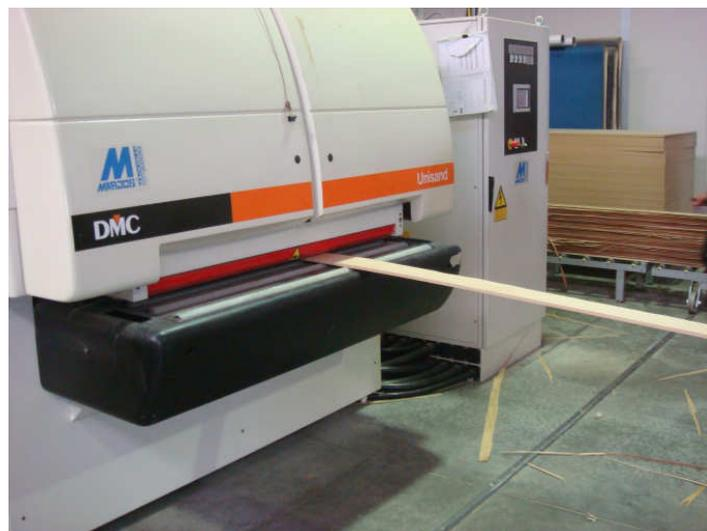
**Figura 15 – Calibradora (máquina)**
