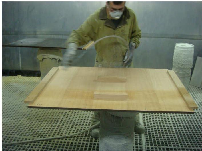
**Figura 27 – Secção de acabamento 1 (aplicação de tapa-poros)**
