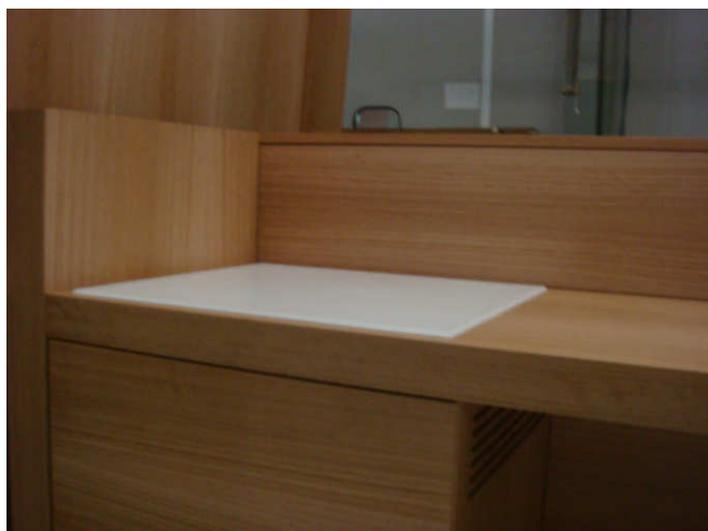
**Figura 29 – Artigo com revestimento a folha e com acabamento**
