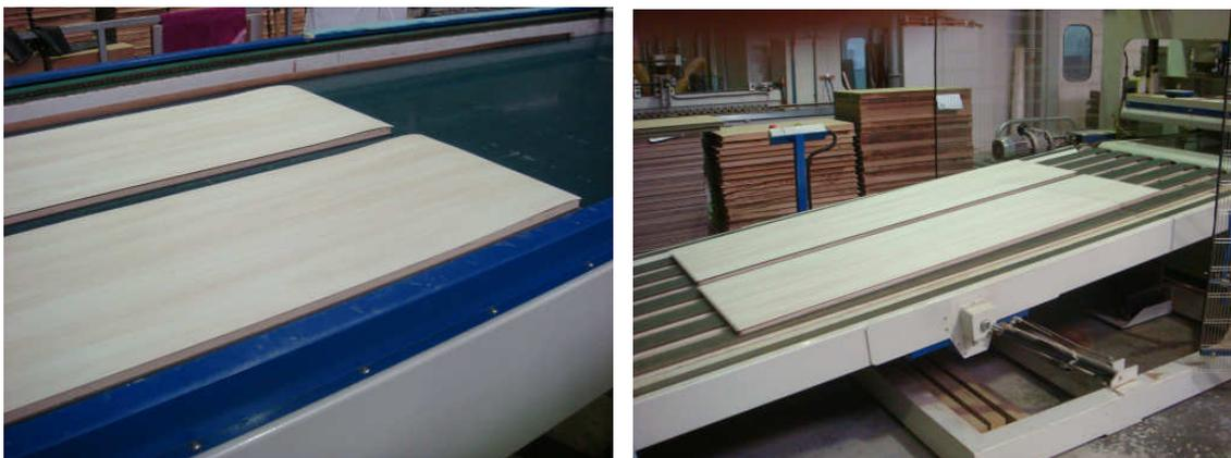
**Figuras 18 e 19 – Secção de folheamento (prensa de folheamento)**
