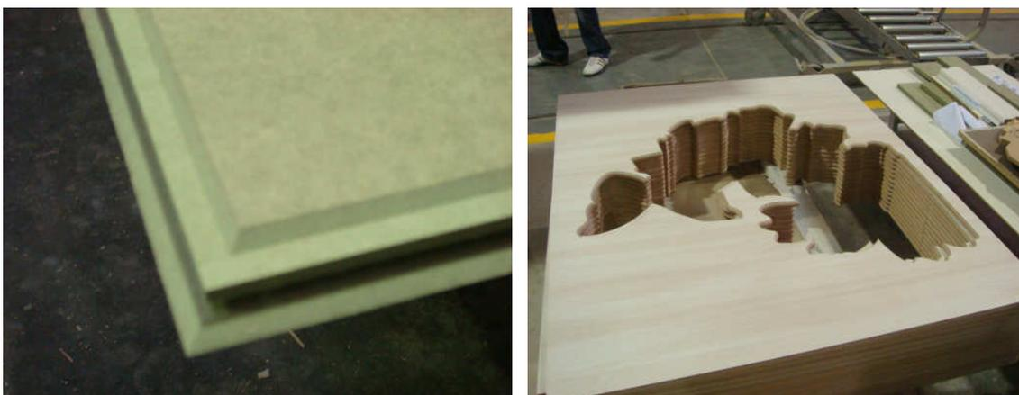
**Figuras 23 e 24 – Componentes que sofreram operação em CNC**
