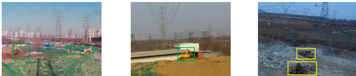
Figura 14, 15 e 16 – Exemplos da detecção de bulldozers e escavadoras
