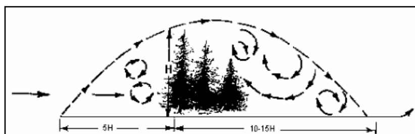
Figura 3.9 - Escoamento a jusante de uma barreira vegetal.
